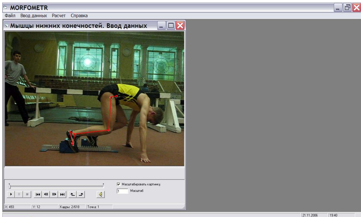
Рис.5.11. Окно ввода координат маркеров и констант, характеризующих места прикрепления мышц. 1 – линия тяги мышцы имитируется прямой линией; 2 – линия тяги мышцы имитируется поманной пинией:
