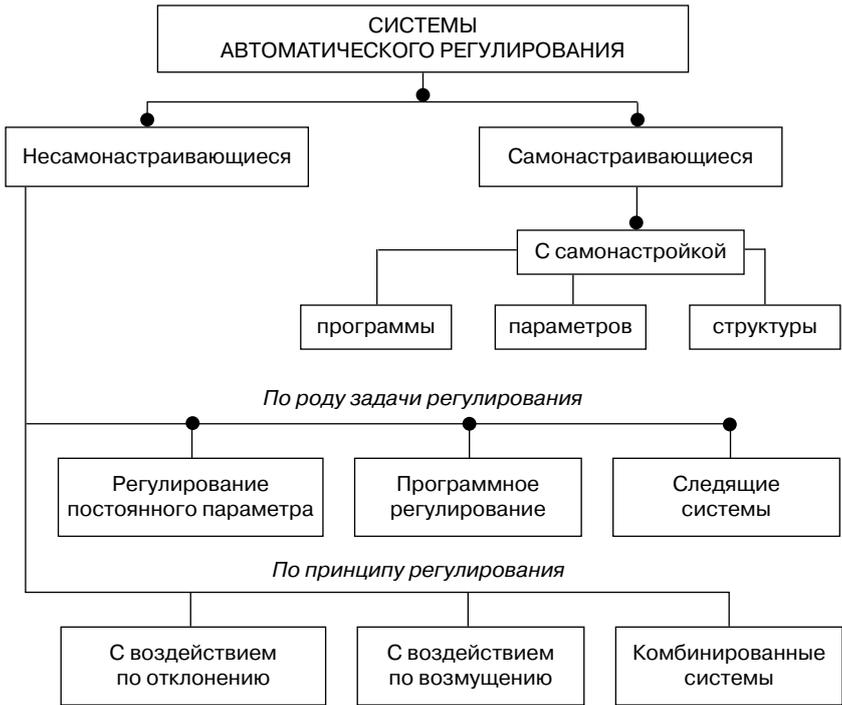
**Рис. 11.** Системы автоматического регулирования с изменениями (по Е.П. Попову)
