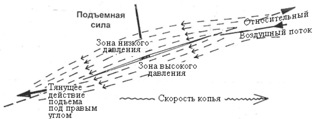
Рис. 14. Основные силы, влияющие на аэродинамические свойства копья в воздушной среде.
