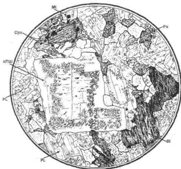
3.92-rasm. Porfirimon granodiorit. d=5,6 mm. Analizatorsiz. Jins kaliyli dala shpati (ortoklaz-kriptopertit), plagioklaz, Cpx (avgit), biotit va o'zgina kvarsdan tashkil topgan. Qurama tog'lari. Daxchali dovoni (G.M.Fulde).
