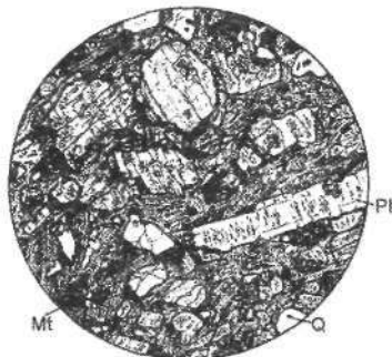
3.86-rasm. Datsit. d=2,4 mm. Analizatorsiz. Jins plagioklaz, kaliy-natriyli dala shpati, kvars, amfibol va biotit ajralmalardan iborat. Barchasining shakli chiqiqsimon. Asosiy, shishasimon massa (50 %) kristallanib mikrofelzitga aylangan. Tuzilishi kristalloklastik va ko'pincha avtomagmatik brekchiyalarga xos. Qurama tog'lari. Kristallarning chiqiq shakliga ahamiyat berish zarur. Rangli minerallar to'la opatsitlashgan, ya'ni gematit, magnetitga aylanadi. Tuzemgan soyning o'ng qirg'og'i (V.N.Baykov kolleksiyasi).
