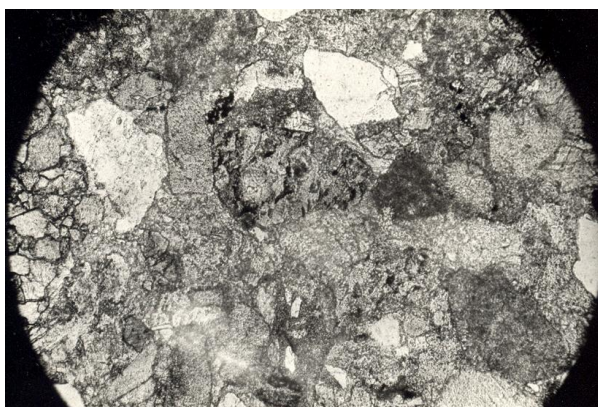
12-расм. Йирик донали полимикт таркибли =умтошларда \овакли типдаги карбонатли цемент микрофотосурати. Н 11, 50 x
