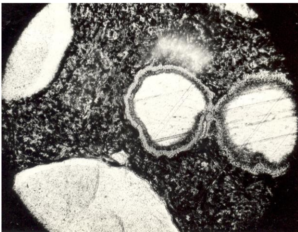
42-расм. Миндалекаменли спилитнинг микрофотосурати. Заррабинда 30 марта катталаштирилган.
