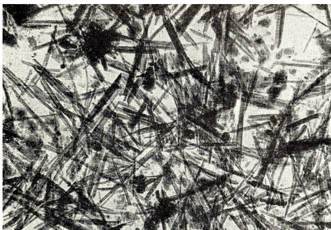
52-расм. Палигорскитли гилларининг электро-микроскопик фотосурати.
