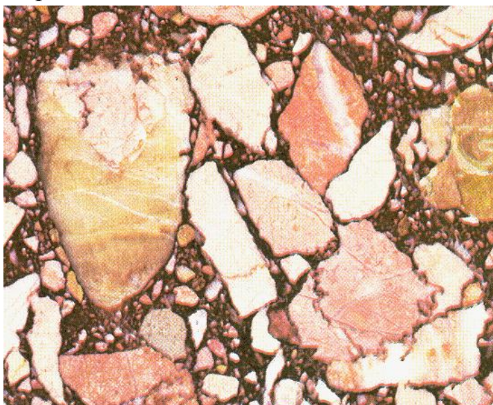
38-рasm. Брекчия структурасининг фотосурати. Былаклари =иррали, цементи карбонатли, базалли. Тылдирувчи масса щам =иррали былакчалардан таркиб топган.
